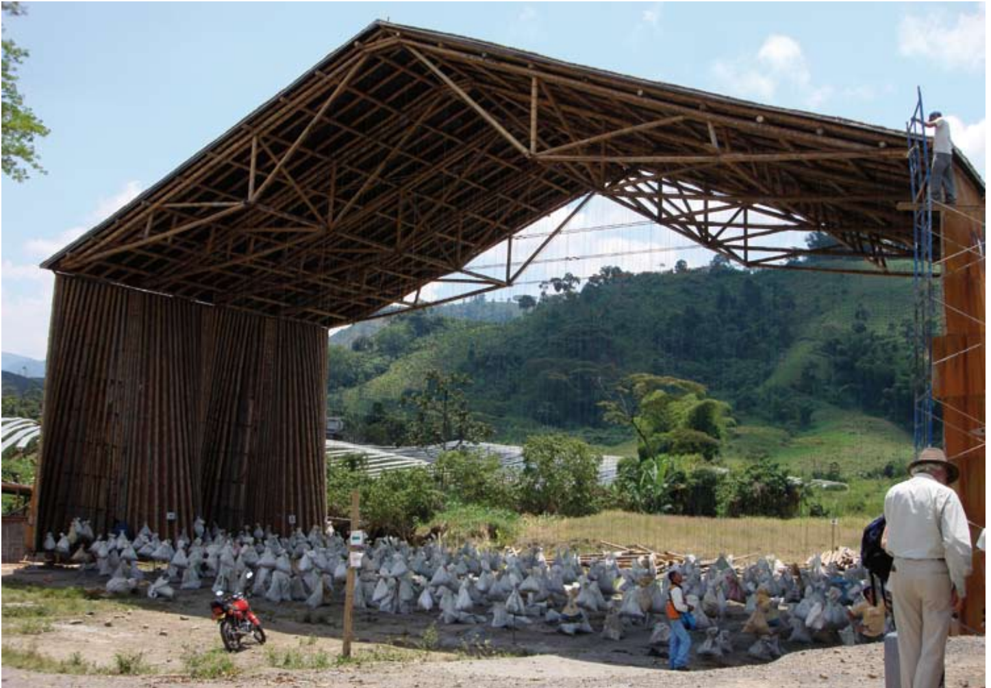
Colombie, essais de charge d'une charpente appuyée sur des surfaces réglées. / Colombia, load tests for a frame resting on the ruled surfaces.
