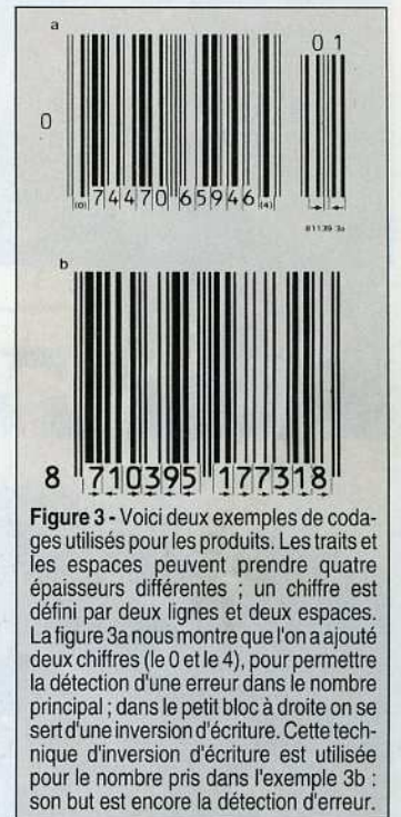
Figure 3 - Voici deux exemples de codages utilisés pour les produits. Les traits et les espaces peuvent prendre quatre épaisseurs différentes ; un chiffre est défini par deux lignes et deux espaces.
