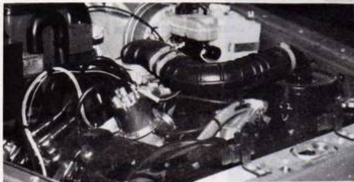
Moteur 4 cylindres en ligne - Allumage transistorisé.
