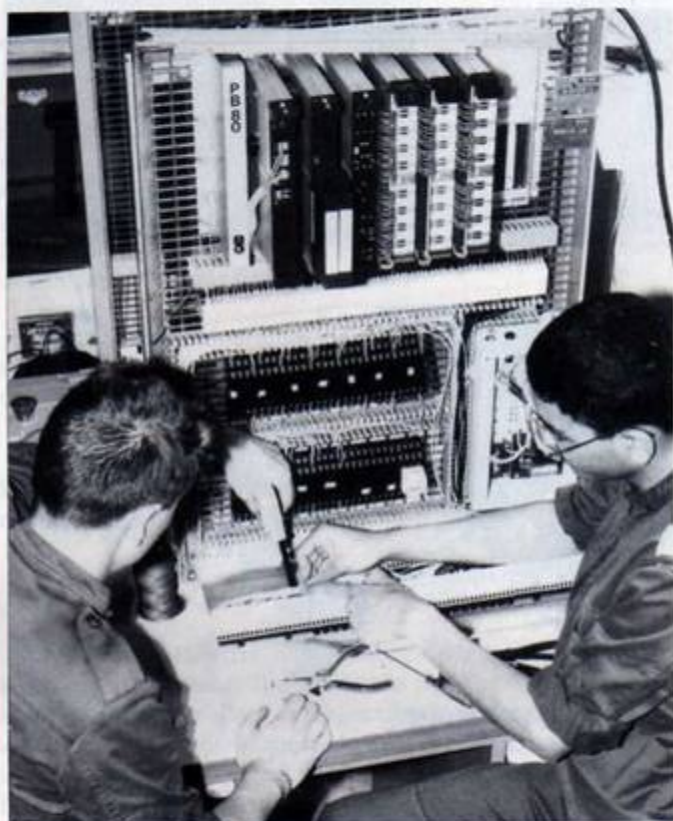
Raccordement d'un automate programmable par des élèves de TF3 - Division électrotechnique - de l'E.N.T.S.O.A. (Automatisation d'une perceuse).
