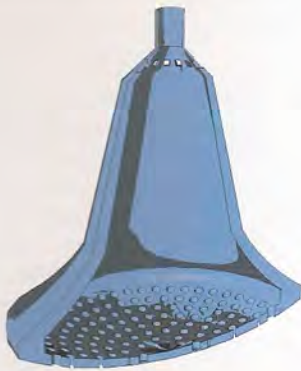
Un pommeau mélangeur incorpore de l'air à l'eau juste avant qu'elle sorte du tuyau.
