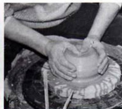
Photo 3 Vient ensuite l'opération déterminante qui consiste à « centrer » la boule de terre. Dans cette séquence, le potier a toujours beaucoup de mal pour expliquer les gestes qu'il fait, car il n'y a pas de véritable recette.
