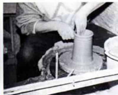
Photos 4 et 5 La boule est centrée, le potier amorce le trou central qui lui permettra de « monter » son cylindre. Cette séquence est toujours très spectaculaire et donne au néophyte une impression de facilité qu'il convient de temporiser en prenant conscience des heures de travail qui ont été nécessaires à l'acquisition d'une telle maîtrise.
