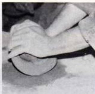
Photo 2 Cette terre, rassemblée sous l'aspect d'une boule est placée par le potier sur la « girelle » de son tour.
