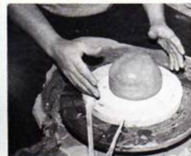
Photo 2 Cette terre, rassemblée sous l'aspect d'une boule est placée par le potier sur la « girelle » de son tour.
