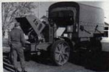
Camion LATIL TAR de 1915 - 4 roues motrices et directrices - vitesse 18km/h - moteur 4 cylindres de 40CV à 1200 tr/mn (prêté par la fondation Marius BERLIET).
